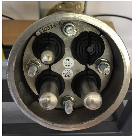
Abbildung 2: Prüfaufbau GE 101 5.1 Gasdichtigkeit, DN 100
